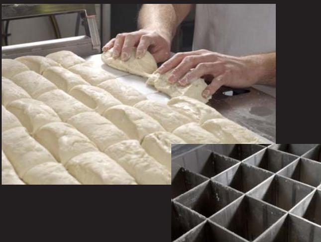
Der Hydraulik Teigteiler Divimach 10/20 ist ein Vollautomat zum schonenden Teilen von Teige in 10 und 20 Stücke.
