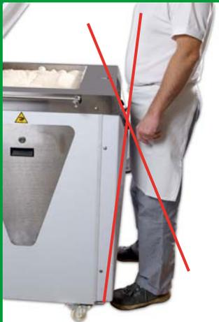
Die Front wurde um die Steuerungstafel der Divimach geformt. Damit ist insbesondere ein nahes Arbeiten an der Maschine möglich, was den Kraftaufwand zum Manipulieren der Teigmasse am langen Arm reduziert.
